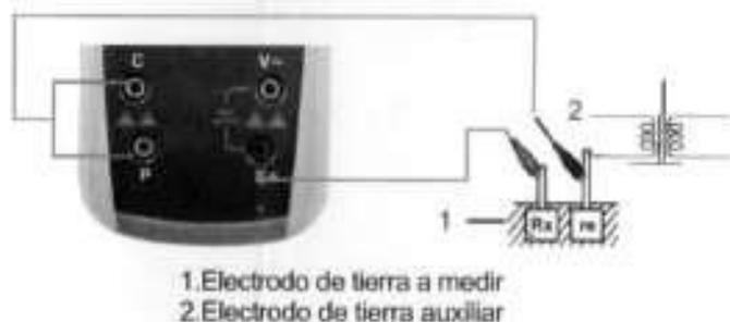
Nota: Al utilizar una puesta a tierra de una compañía eléctrica distribuidora tener precaución con las tensiones que se puedan presentar. No utilice este instrumento para medir tensiones en dichos puntos. Una tensión superior a
